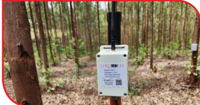
«سنسایوتک» وسیله‌ای به اندازه یک تلفن هوشمند ساخته که می‌تواند ۱۴ متغیر مختلف را در بستر جنگل اندازه‌گیری کند
